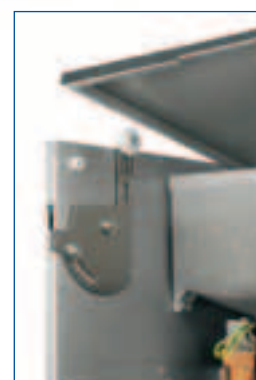
El cierre de la máquina no es posible con la tapa abierta
